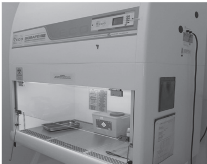
FIGURA 47 – EXEMPLO DE CABINE DE SEGURANÇA BIOLÓGICA DE FLUXO VERTICAL
