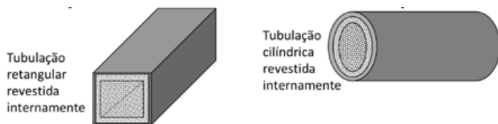
FIGURA 22 – TUBULAÇÃO REVESTIDA INTERNAMENTE PARA ATENUAÇÃO DE RUÍDO DE DUTOS
