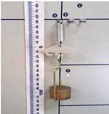
Figura 4 Ensaio estático das molas. Fonte: O autor (2016).
