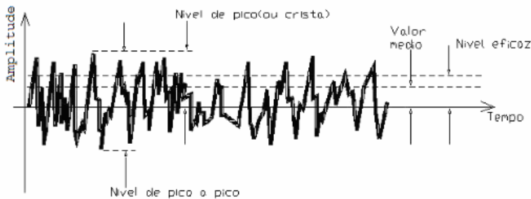
Figura 6. Valores globais de medida de vibração para um sinal de vibração complexo.
