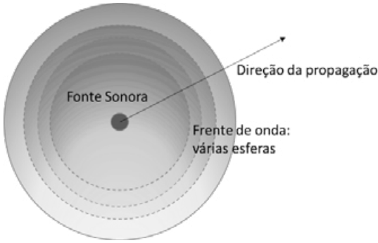
FIGURA 2 – ESQUEMA DE PROPAGAÇÃO ESFÉRICA DE UMA FONTE SONORA PONTUAL.
