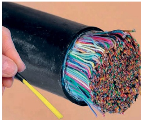
FIGURA 8 - COMPARAÇÃO ENTRE CABO DE FIBRA ÓTICA E FIOS DE COBRE
