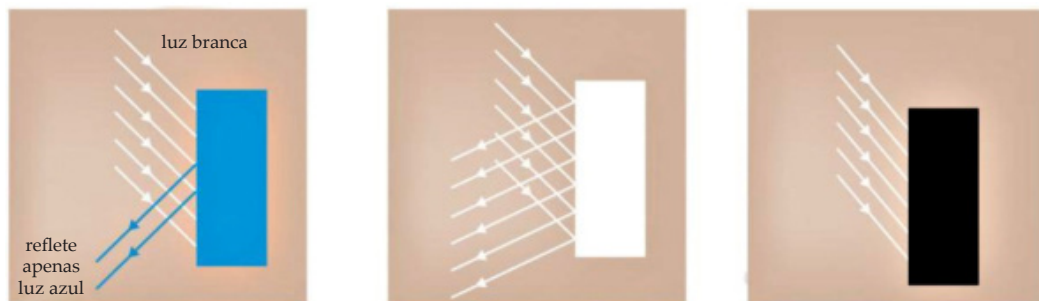
FIGURA 16 - ESQUEMA DO COMPORTAMENTO DA LUZ BRANCA INCIDINDO EM OBJETOS DE DIFERENTES CORES
