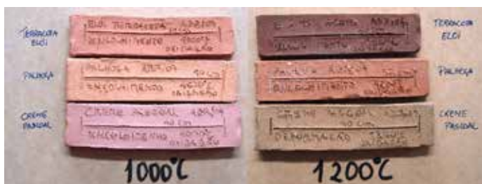
FIGURA 137 – TEMPERATURA PARA QUEIMA DA MASSA
