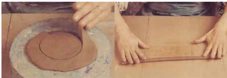
FIGURA 108 – CRIANDO A BASE PARA O ACORDELADO. FAZENDO O CORDEL
