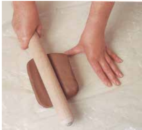
FIGURA 91 – ESTIRANDO O BLOCO DE ARGILA
