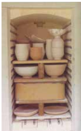
FIGURA 135 – FORNO PREPARADO PARA QUEIMA DE BISCOITO
