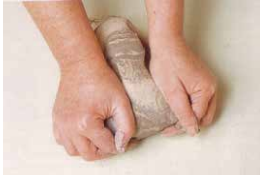
FIGURA 86 – AMASSANDO NA TÉCNICA DA “CABEÇA DE BOI”
