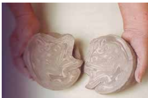
FIGURA 85 – ARGILA SENDO AMASSADA NA TÉCNICA DA ESPIRAL, MAS AINDA NÃO ESTÁ PRONTA PARA USO, NÃO ESTÁ HOMOGÊNEA
